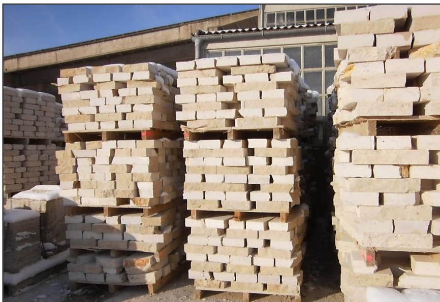
Schichtmauerwerk Jura Höhe 8 cm
